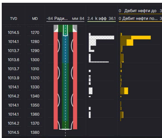
Рисунок 2.6 – Дебит нефти до и после гидромониторной обработки
